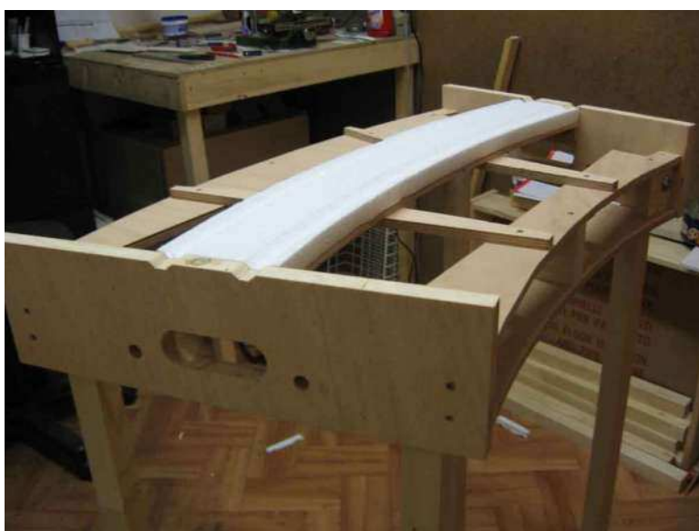
Uloženie polystyrénu s vyrezanými žľabmi
