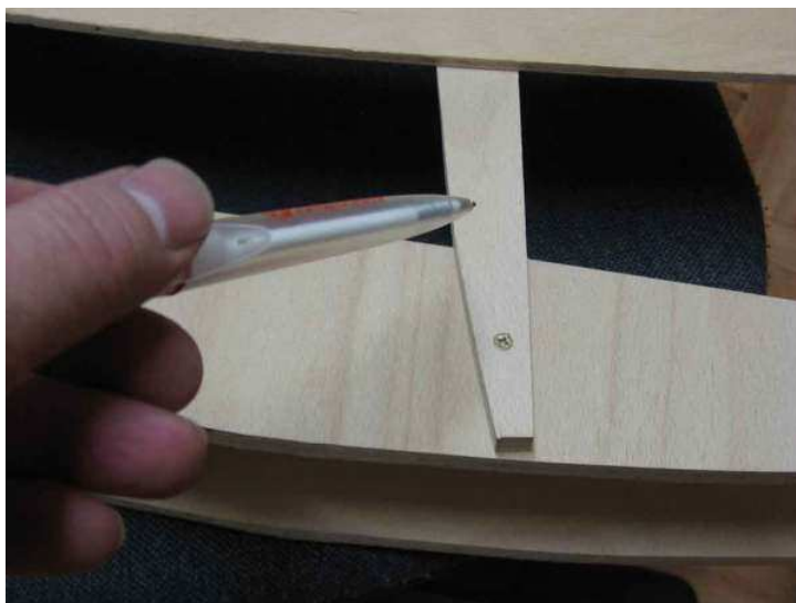
Priečna výstuha pre uchytenie nosnej preglejky
